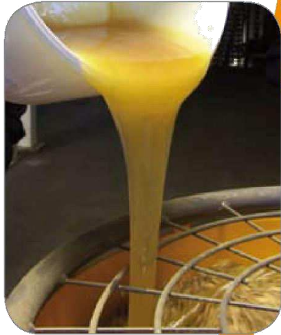
Pour the mixed resin into the mixer
